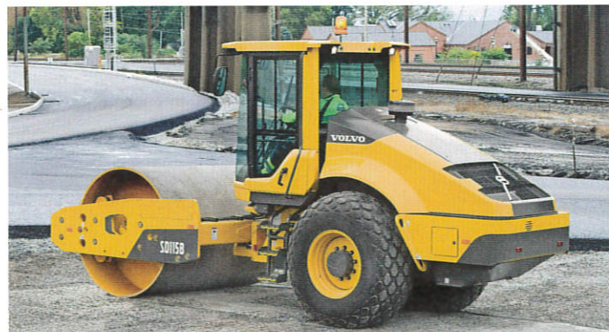
Volvos neue Erdbauwalzen der B-Serie: bedienerfreundliche Konsole für die Einstellung von Frequenz und Amplitude.
